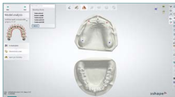
4 Scansionare o importare i dati scansionati, definire il piano occlusale ed eseguire l'analisi del modello come di consueto.
