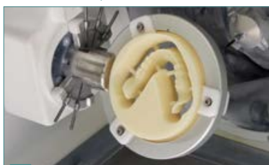
4 Fresare il disco in cera per il try-in in cera a dimensione intera (arcata inferiore).
