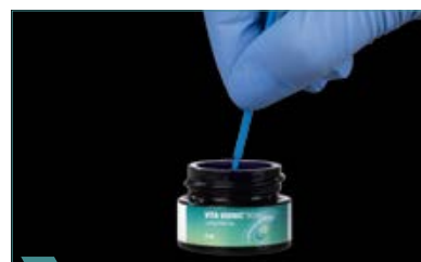
3 Mescolare per 30 secondi i due componenti evitando la formazione di bolle.
