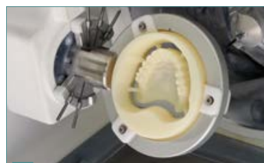
3 Fresare il disco in cera per il try-in in cera a dimensione intera (arcata superiore).
