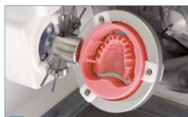
3 Fresare i dischi in cera (arcata superiore e inferiore) per la prova.
