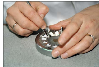
Abb. 50a/b: Manuelles Einlegen der Zahnmasse in die Zahnform bei der Fertigung von VITAPAN Frontzähnen.
