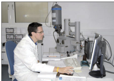
Zum High-Tech-Equipment der VITA Labore für die Qualitätskontrolle gehört u. a. ein Rasterelektronenmikroskop.
