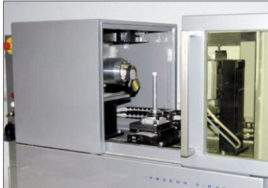
Risse im Materialgefüge von CAD/CAM-Rohlingen können im Computertomografen erkannt werden.
