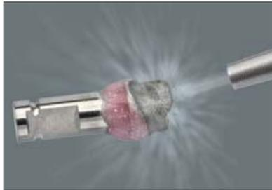
Arenar con cuidado únicamente la superficie de adhesión de la base de titanio con  $Al_2O_3$ ,
